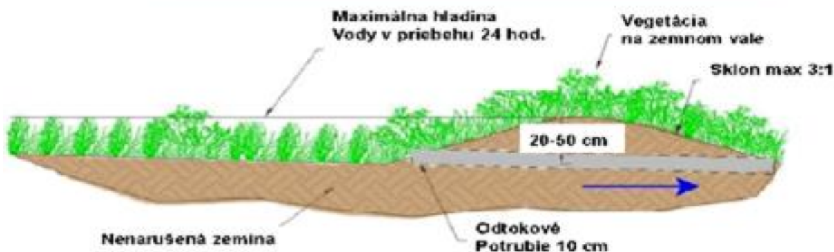
Obr. č. 18 Schematický detail zdrže (archív MVO Ľudia a voda)
